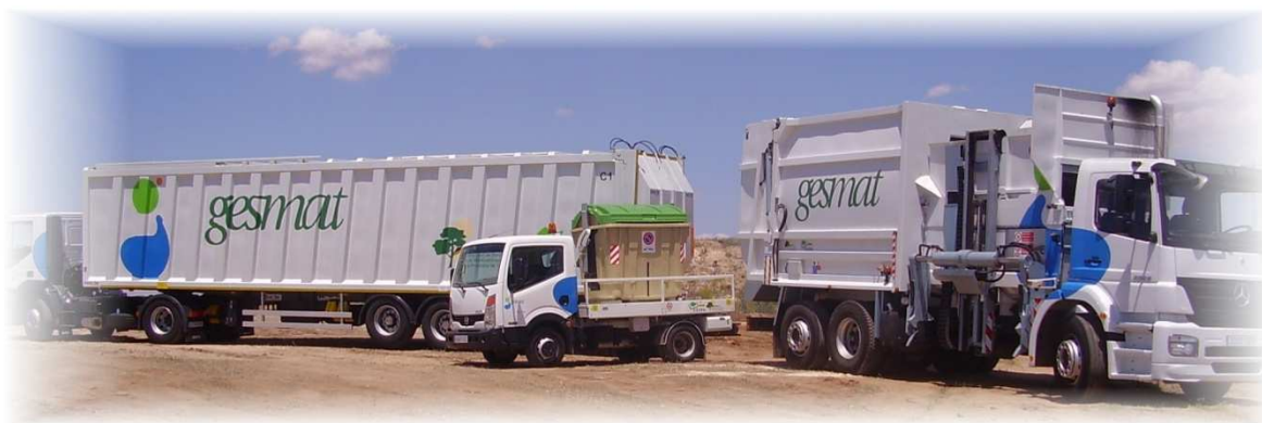
Piso móvil; vehículo satélite y vehículo compactador
