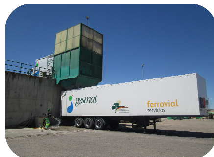
Estación de transferencia de piso móvil
