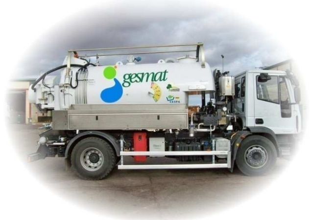
Equipo para la limpieza de la red de alcantarillado
