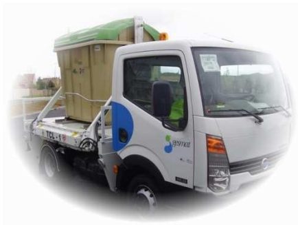
Vehículo satélite para la recogida mediante carga lateral
