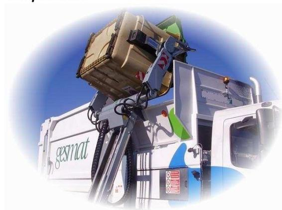
*Vehículo compactador para la recogida mediante carga lateral*
