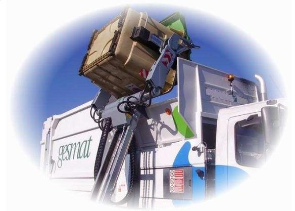
*Vehículo compactador para la recogida mediante carga lateral*
