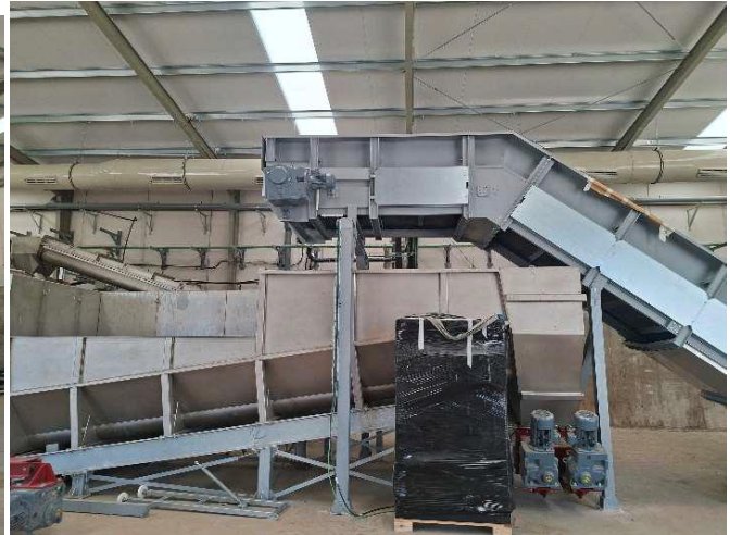
IMPLANTACIÓN ABREBOLSAS: Instalación de abrebolsas y alimentador a tolva de triturador
