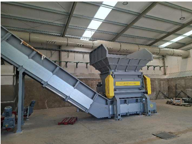
IMPLANTACIÓN ABREBOLSAS: Instalación de abrebolsas y alimentador a tolva de triturador
