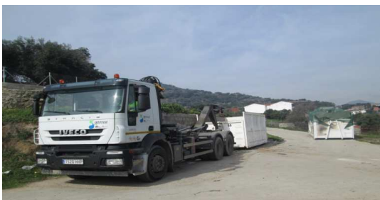
Recogida de contenedor de 25m 3 con vehículo portacontenedores
