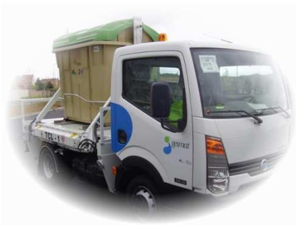
Vehículo satélite para la recogida mediante carga lateral
